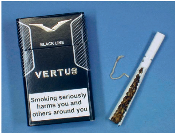
Etwa vier Zentimeter lange beigefarbene Schnur aus Polyester, bei deren Verbrennung unangenehm riechende und in hohem Maße gesundheitsgefährdende Zersetzungsprodukte entstehen können.
